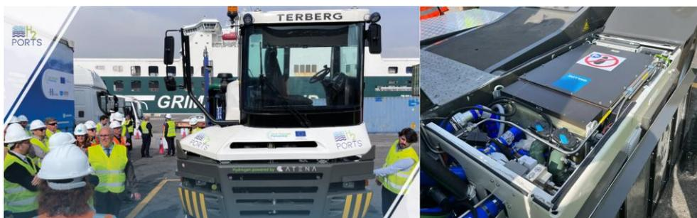
**Figura 14.** Yard Truck Terberg YT203-H2 propulsado con celda Ballard, para ser probado en el puerto de Valencia – Programa H2Ports[32].
